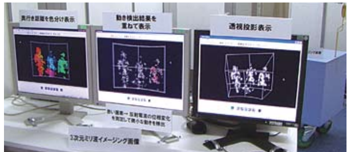
図4：煙、布、木材などの遮へい物によって隠された被写体を、電波を利用して撮影するミリ波イメージング技術の研究紹介。ミリ波を送受信して被写体の3次元空間上の位置情報を取得し、リアルタイムに可視化することができる。
