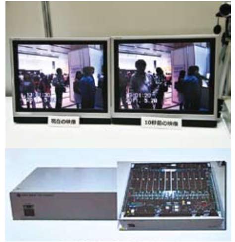
写真4：展示会場内に設置したカメラにて、現在と10秒前の比較映像を展示(上)。発生直後の映像を記録したスキップバックレコーダーとその内部(下)
