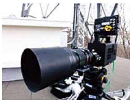
写真2：仮設したEM-CCDカメラと望遠レンズ
