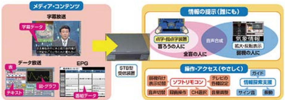
図2：視覚に障害のある人のための情報バリアフリー受信提示システムの仕組み
